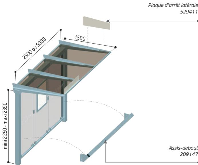
Attention : ne pas installer de banc ou d'assis-debout à proximité du caisson lumineux ou de la vitrine "2000" afin de ne pas en bloquer l'ouverture.
